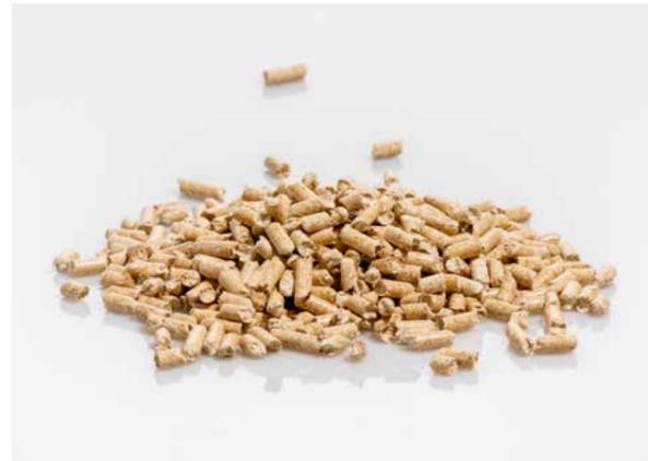
Die Stämme werden zu Schnittholz und das beim Sägen anfallende Sägemehl zu Holzpellets verarbeitet. Diese verbrennen CO<sub>2</sub>-neutral und leisten dadurch einen aktiven Beitrag zum Klimaschutz.
