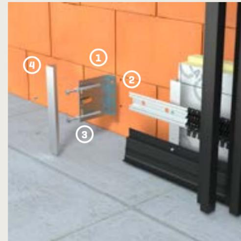
Zur Befestigung des Stützprofils und des unteren Trägers wird ein L-Profil verwendet, das an einer Profilstütze befestigt wird. Die Länge der Profilstütze ist abhängig von der gewählten Dämmstoffstärke.
