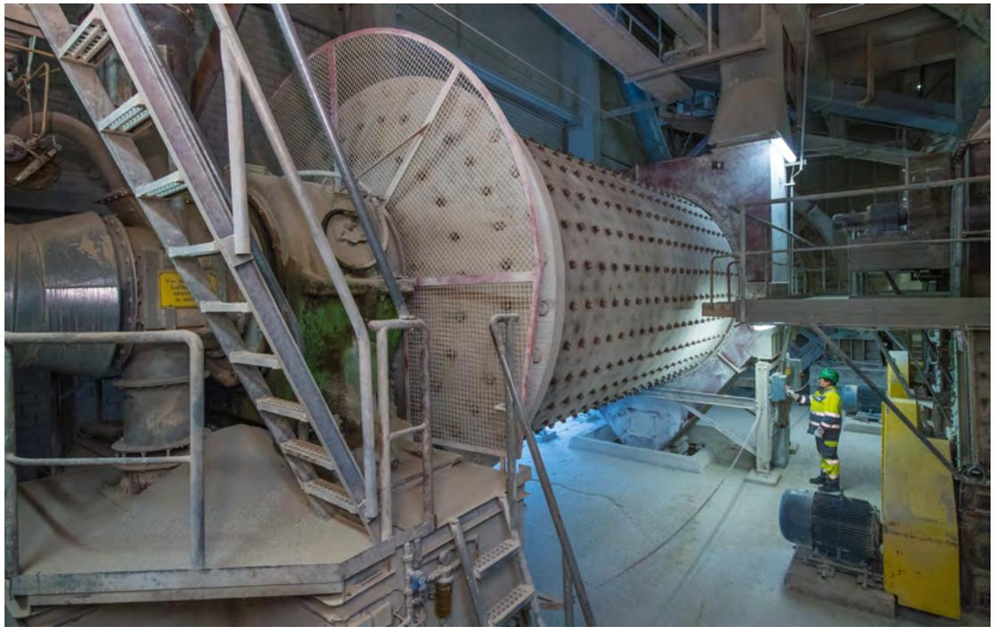
Der letzte Produktionsschritt bei der Zementherstellung ist die Vermahlung von Zementklinker und weiteren Bestandteilen. Er ist auch deshalb bedeutsam, weil an dieser Stelle entscheidende Optimierungen möglich sind: Sogenannte Mahlhilfsmittel und Performance-Additive können hier hinzugefügt werden. Diese erzielen mit einer sehr geringen Dosierung eine beachtliche Wirkung.
