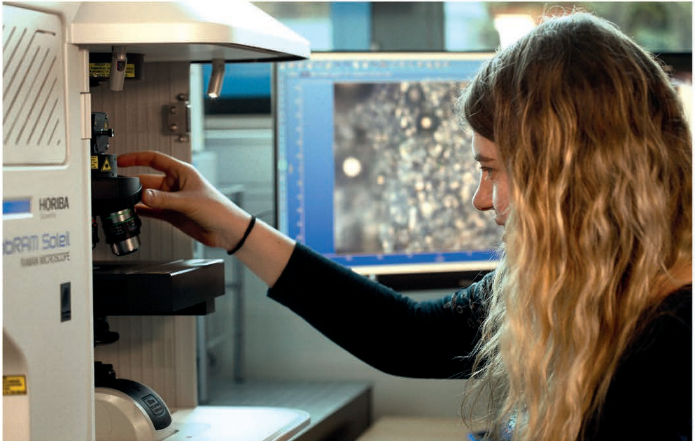
Untersuchung einer Kunststoffprobe mit der Raman-Spektroskopie. (Foto: Horiba Scientific)
