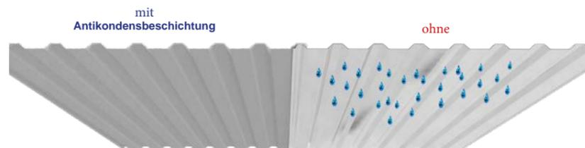
**Wie funktioniert eine Antikondensbeschichtung?**
