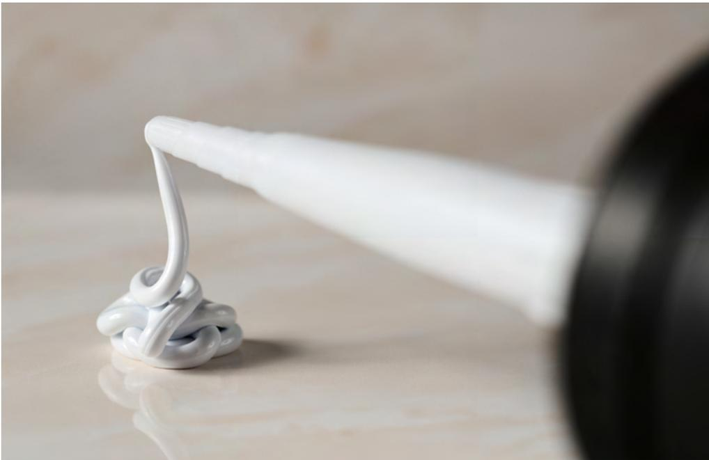
härtung von Polyurethanen ist eine Polyadditionsreaktion von Polyolen mit Polyisocyanaten. Die Verarbeitung erfordert entsprechend geschultes Personal. Je nach Produkt sind ggf. zusätzliche Schutzmaßnahmen zu beachten. Nach Aushärtung sind Polyurethane chemisch und biologisch inert.
