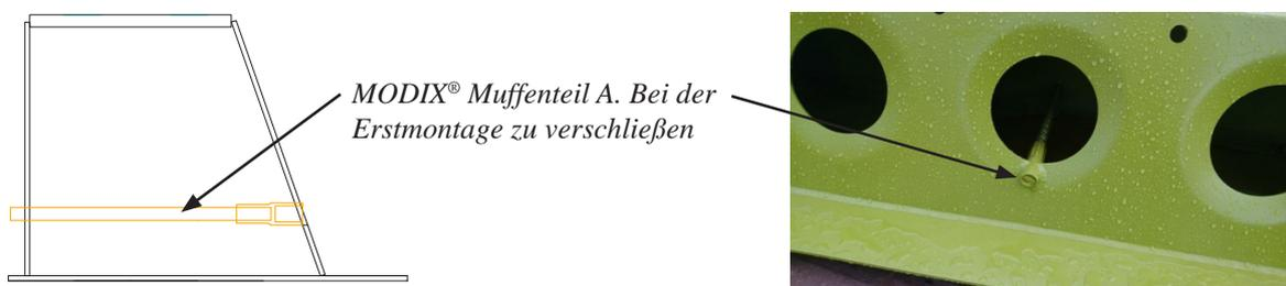
Abbildung 17. Anordnung der MODIX® Schraubmuffe
