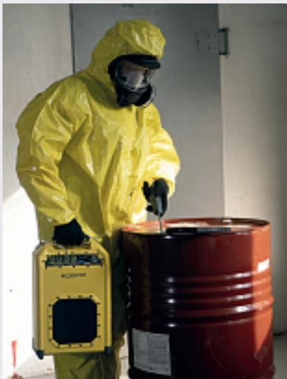
Nanocolor Advance von **Macherey-Nagel (Halle A2, Stand 322)** vereint die wichtigsten Eigenschaften eines tragbaren Kompaktphotometers und eines hochpräzisen Spektralphotometers. Mit seinem Akku kann das Gerät mobil und universell in der Wasser- und Abwasseranalytik eingesetzt werden.
