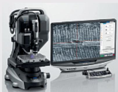
VHX-7000 an. Nutzer wechseln problemlos vom Mikroskopieren zur Materialanalyse. Die Untersuchung gelingt ohne zeitaufwendige Präparation, Leitfähigkeitsbehandlung und Vakuum.
