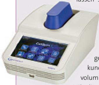
lassen sich DNA, RNA und Proteine schnell quantifizieren. Die Messung gelingt in weniger als drei Sekunden in Proben volumina ab einem Mikroliter.
