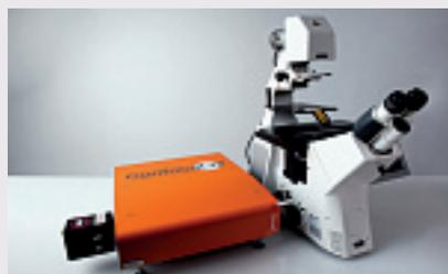
des Weitfeldmikroskop zu einem Konfokalmikroskop aufrüstet. Die Technik liefert hochkontrastreiche, superaauflösende Bilder auch im NIR-Bereich.
