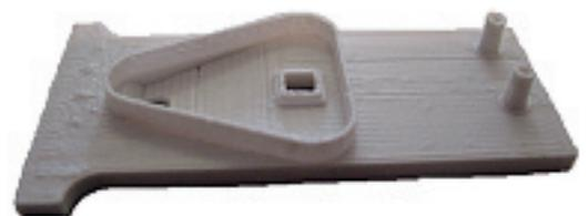
Für Experimente zur chemischen Stimulation von Zellen: Kulturkammer aus dem 3D-Drucker. (Foto: FAU Erlangen-Nürnberg)
