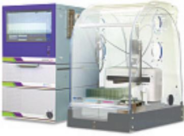
*Sicherer Umgang mit fluidem Kohlendioxid: Der eingehauste Autosampler wird an die Laborabsaugung angeschlossen.
