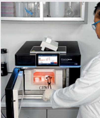
Vorveraschung sowie das Abkühlen der Porzellantiegel im Exsikkator nach der Veraschung entfallen. Die Tiegel werden nach zehn Sekunden Abkühlzeit gewogen. Ein eingebautes Abluftsystem entfernt Rauch und Dämpfe.
