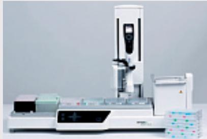
krolitern. Eine automatische Flüssigkeitsstandserfassung sorgt für die optimale Pipettierhöhe.
