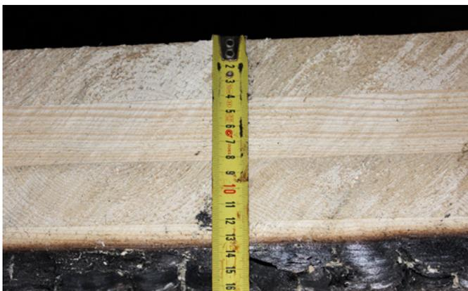
Abbildung 10. Verkohlung in der Mitte der CLT-Spannweite.
