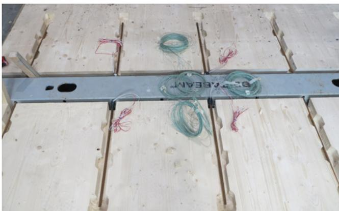
*Abbildung 2. Querbewehrung gewährleistet die Lastübertragung.*
