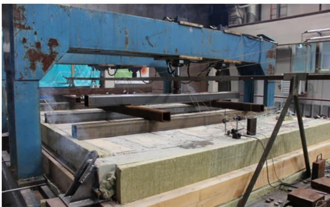
*Abbildung 7. Prüfkörper für den 90-minütigen Brandversuch mit Belastung. Die Lastanordnung simuliert eine Konstruktion aus DELTA BEAM® und CLT-Platten mit 8 m CLT-Spannweite, 1,7 kN/m² ständiger Last und 5 kN/m² Verkehrslast ( $\psi_1=0,7$ ). Der festgelegte Faktor  $\psi_1$  entspricht dem verwendeten Faktor für Gemeindegebiete, Einkaufszonen und Verkehrszonen der Kategorie F.*
