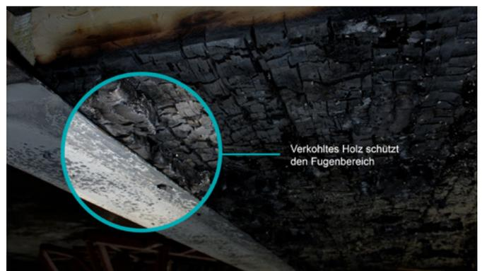
*Abbildung 3. Prüfkörper von unten nach einem 90-minütigen Brandversuch unter Belastung.*
