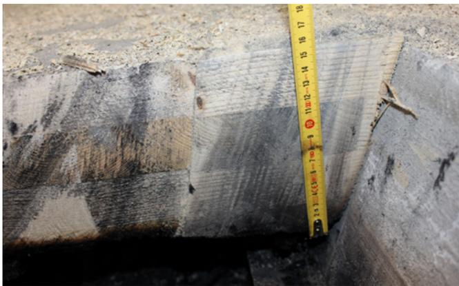
Abbildung 9. Verkohlung im Verbindungsbereich zwischen DELTABEAM® und CLT-Platte neben dem Fugenbeton.
