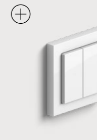
Gira RF Wandsender für KNX Er und der RF Tastsensor für KNX sind batteriebetrieben und können unabhängig von Leitungen als Funk-Wandsender montiert werden – auf der Wand verschraubt, mit Tragrings auf einer UP-Gerätedose und auf alle glatten Flächen geklebt.
