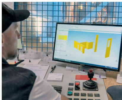
Erstellung von Maschinendaten zur Fertigung von Decken- und Wandabbund
